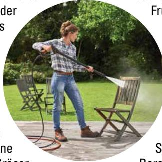
RE 80 mit Flachstrahldüse, idealerweise mit einem Strahlwinkel von mehr als 50 Grad, um empfindliche Oberflächen zu schonen. Auch Moos und Algen auf dem Terrassenbelag lassen sich mit einer rotierenden Waschbürste wirksam beseitigen. Unter stihl.ly/ Fruehjahrsputz finden sich viele weitere Pflegetipps.
