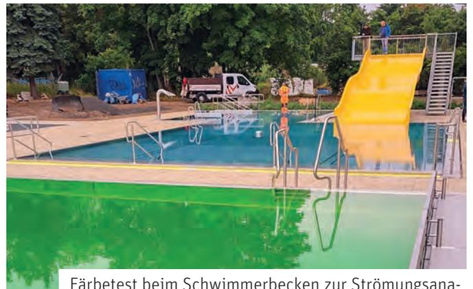
Färbetest beim Schwimmerbecken zur Strömungsanalyse, Nichtschwimmerbereich noch ohne Färbetest (Becken hinten)
